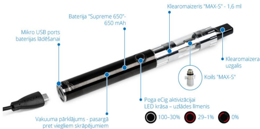
1.att. Elektroniskās cigaretes shēma (Avots: https://www.airpuf.com/kas-ir-elektroniska-cigarete/# )
